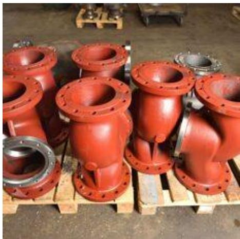
Затворы обратные (клапаны обратные поворотные) предназначены для автоматического предотвращения обратного потока рабочей среды в трубопроводе, например при остановке насоса в системе и т.д. Затворы относятся к предохранительной арматуре.
