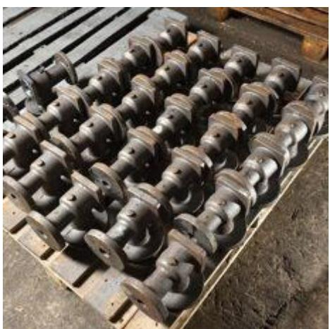
Клапаны относятся к запорным устройствам, служащим для перекрывания потоков газообразных или жидких сред в трубопроводах различных давлений и условных (номинальных) проходов с помощью диска тарелки клапана, при поступательном движении шпинделя-штока (ввинчиваемого в резьбу неподвижной ходовой гайки, расположенной в крышке или бугеле) вдоль оси потока, перпендикулярно к плоскости седла.
